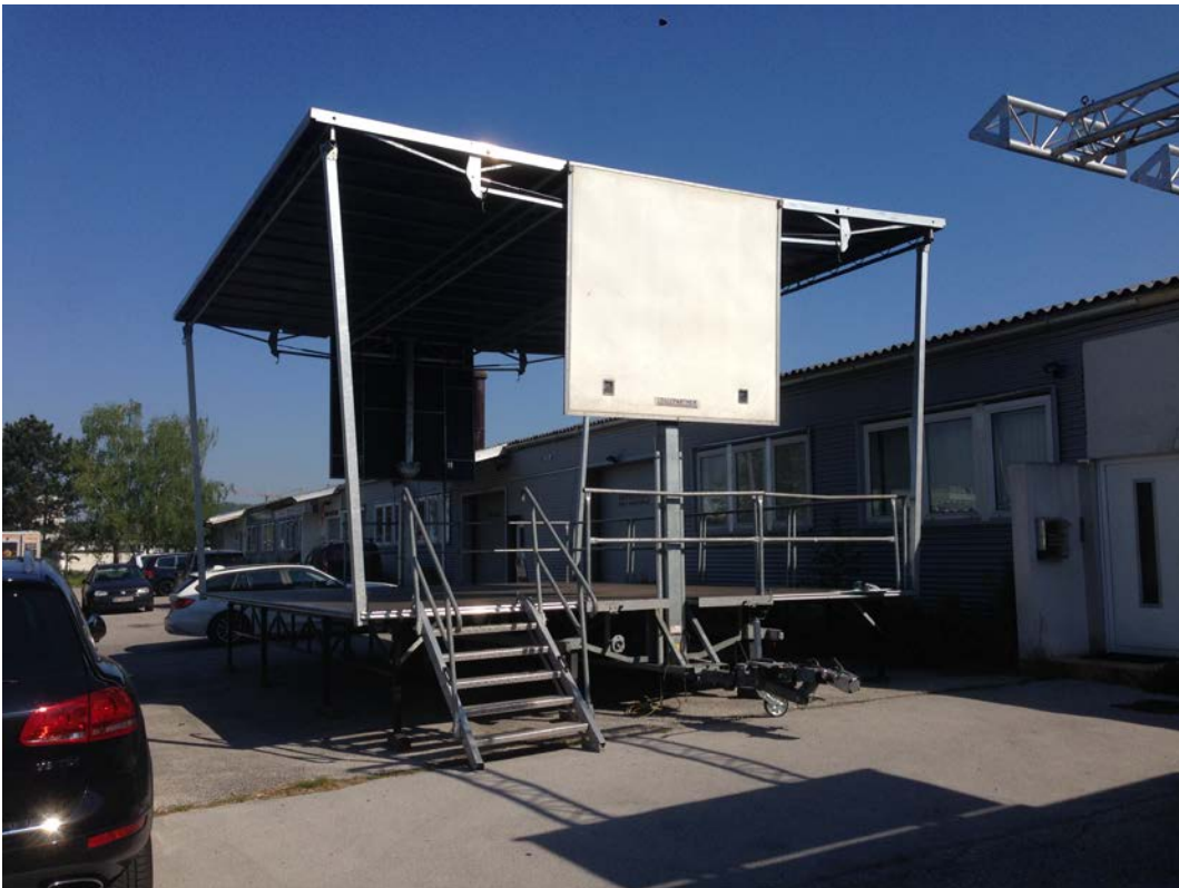
Aufnahme „Trailerbühne“ im errichteten Zustand ohne Seiten- und Rückwandnetze
